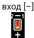
Перемычками «IN» +/- можно поменять полярность входящего сигнала.
