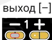
Перемычками «OUT» +/- можно поменять полярность выходящего сигнала.
